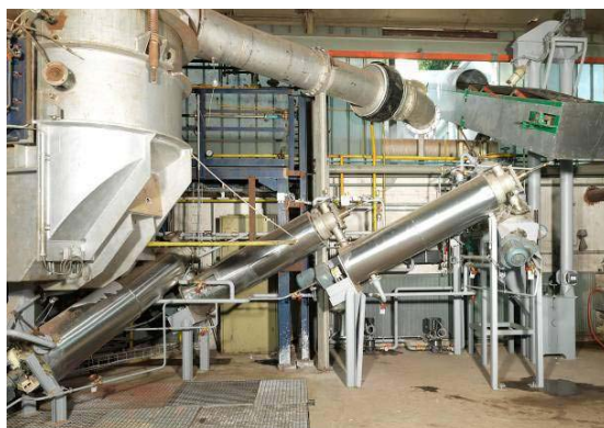
Abb. 37 > ASH DEC Pilotanlage, Ofen und Kühlschnecken
