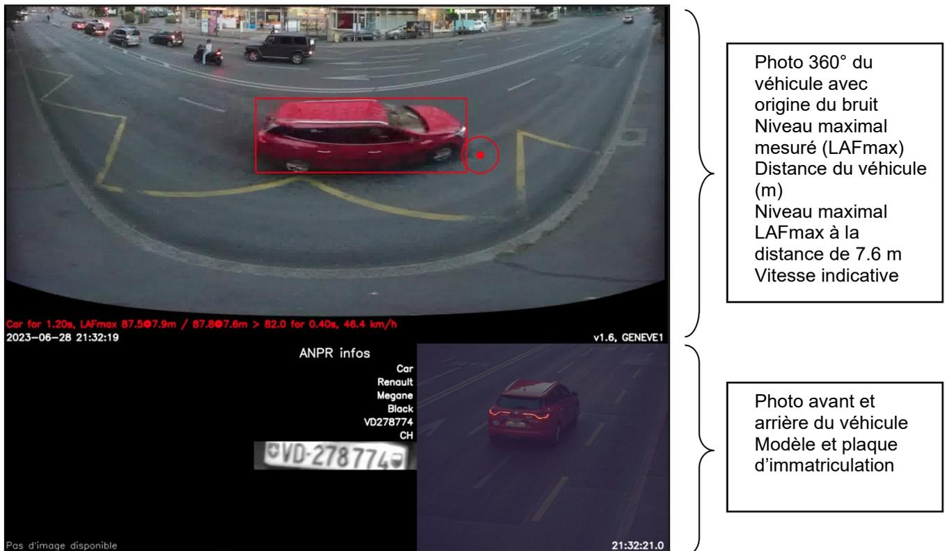
Figure 5 : Exemple de résultats fournis par l'Hydre (voiture test)
