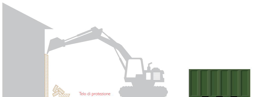
Rimozione isolanti dall'esterno con mezzi meccanici
