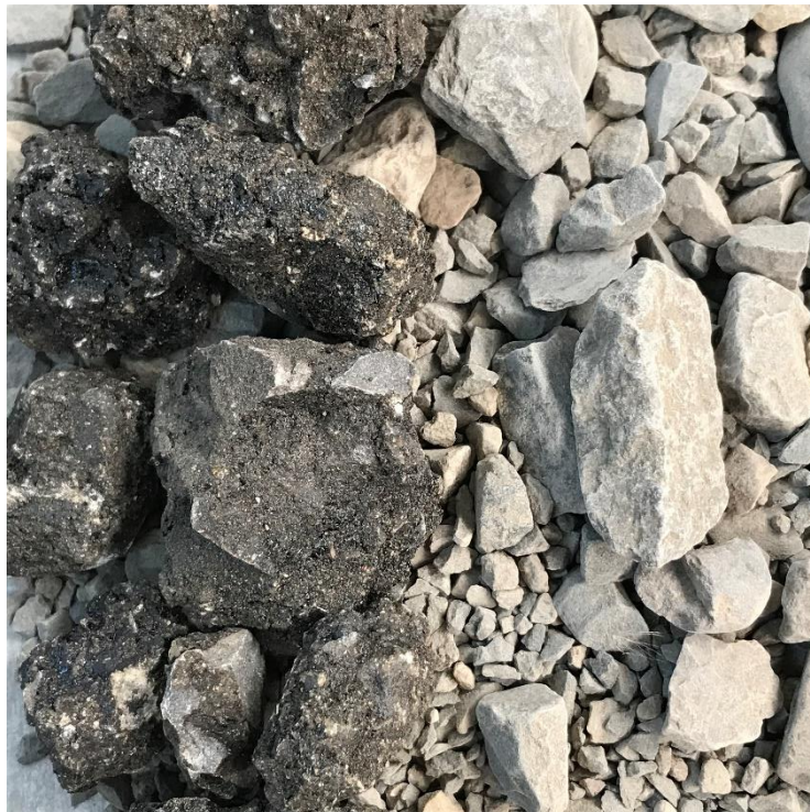
Abbildung 33: Asphaltgranulat 16/70 vor (links) und nach (rechts) der chemischen Reinigung
