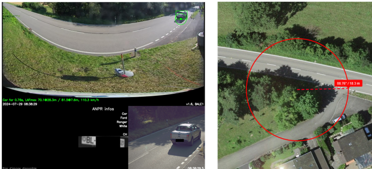
Abbildung 25: Links: PKW-Vorbeifahrt Richtung Röschenz. Hyde gibt die Distanz mit 28.3 m an und rechnet damit den Referenzpegel auf 7.6 m zurück. Rechts: Gemäss Ausmessung beträgt die Distanz zum Fahrzeug eher 18 m. Quelle: map.geo.admin.ch, SwissTopo.
