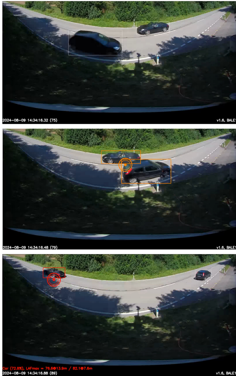
Abbildung 43: Vorbeifahrt Hyde mit Kreuzung zweier Fahrzeuge. Oben: Beide Fahrzeuge werden vom Hyde-Lärmblitzer erfasst und mit einer weissen Box umrandet. Mitte: Zum Kreuzungszeitpunkt sind die Vorbeifahrtpegel vermutlich nicht ganz separierbar. Der resultierende Gesamtschallpegel führt zu einem leicht erhöhten Wert. Möglicherweise wird das Fahrzeug auf der entfernten Fahrspur akustisch abgeschirmt. Unten: Nach dem Kreuzen wird der Porsche als zu laut detektiert.
