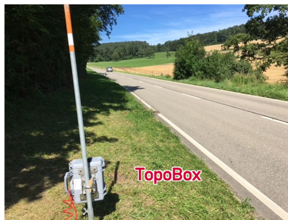
Abbildung 6: Messkoffer der TopoBox, welche die Verkehrszusammensetzung, Geschwindigkeit und Fahrtrichtung der Teilnehmer erfasst.
