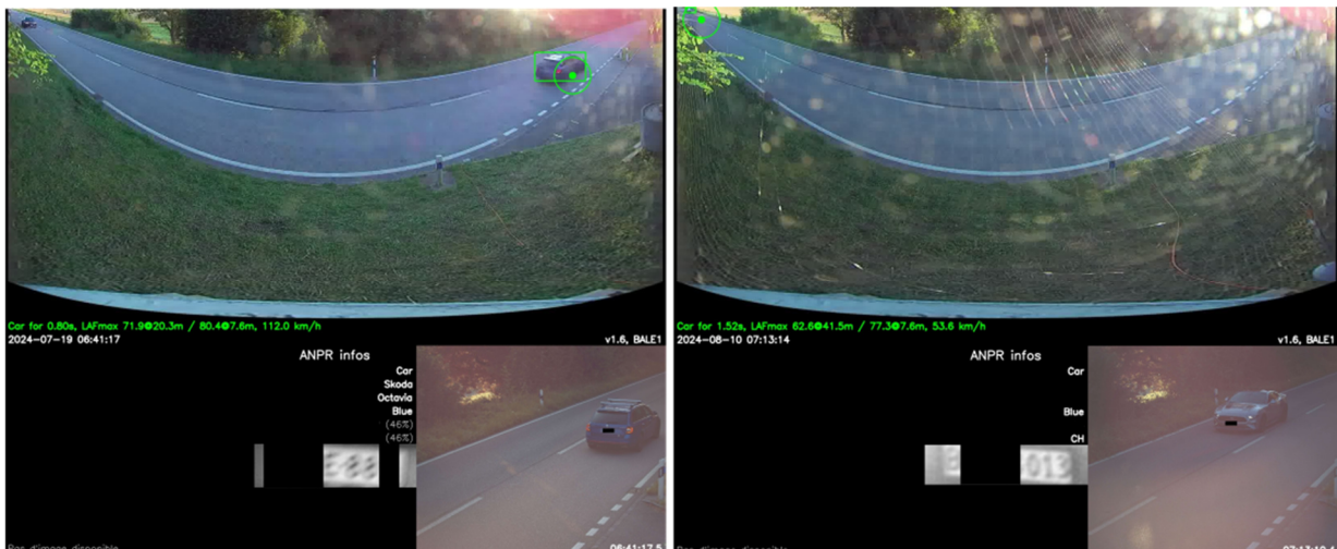
Abbildung 51: Vorbeifahrten Mitte Juli und Anfangs August unter Einfluss der Morgensonne. Bei flachen Sonneneinstrahlungswinkeln ist im August ein Spinnennetz erkennbar. Die von der Hydre ANPR Kamera erfassten Bilder sind ungünstig belichtet und zum Teil verwackelt. Links: 19.07.2024 06:41:17, inkorrekt ermittelte Distanz zum Fahrzeug, Rechts: 10.08.2024 07:13:14, flach einfallende Sonne.
