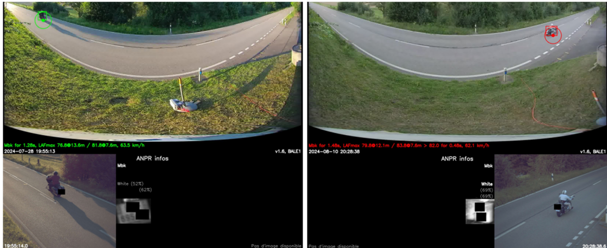
Abbildung 52: Vorbeifahrten Ende Juli und Anfangs August unter Einfluss der Abendsonne. Die von der Hydre ANPR Kamera erfassten Bilder sind ungünstig belichtet und zum Teil verwackelt. Links: 28.07.2024 19:55:13, inkorrekt ermittelte Distanz zum Fahrzeug, Rechts: 10.08.2024 20:28:38.
