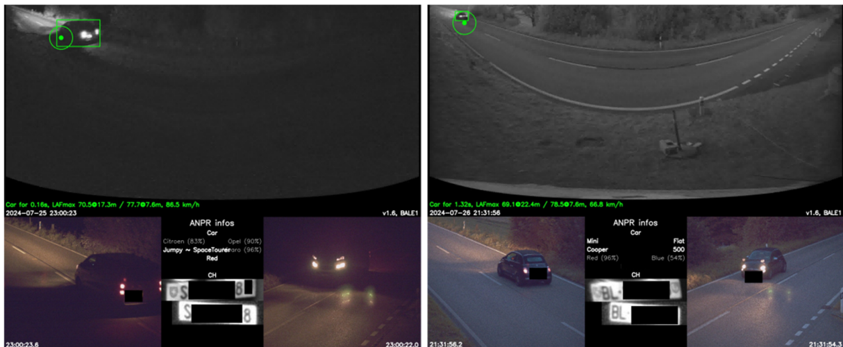
Abbildung 53: Von Hydre erfasste Vorbeifahrten während der Nachtzeit im Juli. Die ANPR Kamera vermag die Nummernschilder auch in der Dunkelheit meistens zu erkennen. Die Farbbilder der Seitenkameras sind aber verpixelt. Links: 25.07.2024 23:00:23, Rechts: 26.07.2024 21:31:56.
