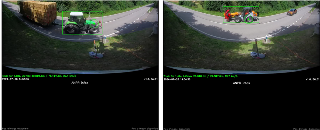
Abbildung 61: Links: Vorbeifahrt Traktor. Geschwindigkeit TopoBox: 28 km/h, L_{A,F,max}@7.6m Validierungsmikrofon: nicht zuweisbar. Rechts: Vorbeifahrt Baustellenfahrzeug. Geschwindigkeit TopoBox: 29 km/h, L_{A,F,max}@7.6m Validierungsmikrofon: 80.6 dB(A).
