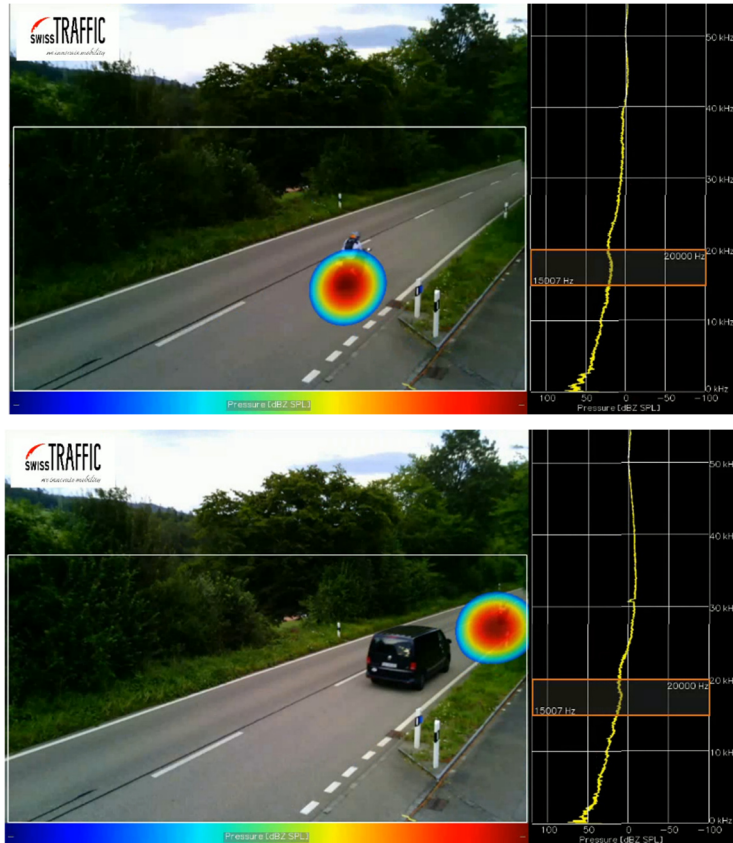
Abbildung 45: Von swissNoise am 02.08.2024 um 19:40:17 detektierte Vorbeifahrt eines Motorrads gefolgt von einem PKW. Die Hauptquelle wird korrekt dem Motorrad zugewiesen, die ANPR-Kamera und die Metadaten geben aber das Nummernschild des PKWs an.
