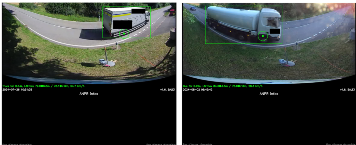
Abbildung 24: Vorbeifahrt von LKWs unter dem Schwellenwert von 82 dB(A) bei denen der lauteste Punkt nahe beim Lärmblitzer registriert wurde. Links: L_{A,F,max}@6.8m,Hydre: 79.0\text{ dB(A)} , L_{A,F,max}@7.6m, Hyde: 78.1\text{ dB(A)} , L_{A,F,max}@7.6m} Validierungsmikrofon: 82.1 dB(A). Rechts: L_{A,F,max}@3.6m,Hydre: 84.6\text{ dB(A)} , L_{A,F,max}@7.6m, Hyde: 78.0\text{ dB(A)} , L_{A,F,max}@7.6m} Validierungsmikrofon: 83.3 dB(A).
