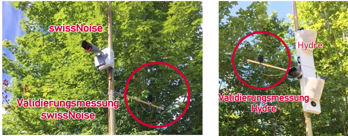
Abbildung 5: Platzierung der Klasse 1 Nor1297 Mikrofone für die Validierungsmessungen beim swissNoise (links) und beim Hydre (rechts) Lärmblitzer.
