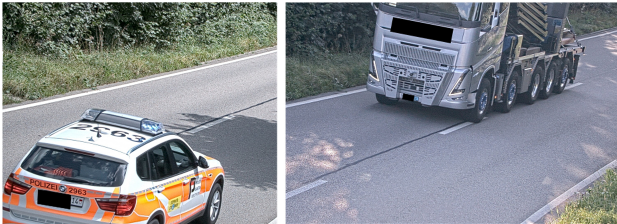
Abbildung 50: Beispiele von nicht korrekt ermittelten Nummernschildern bei guter Bildqualität beim swissNoise-Blitzer. Das Nummernschild des Polizeifahrzeugs wurde als «N2963» ermittelt und für den Lastwagen wurde «"IIIIII11"» angegeben.
