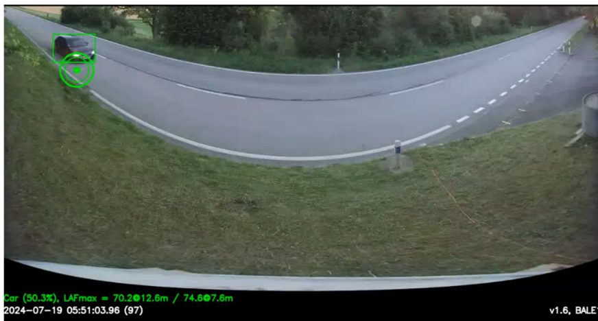
Abbildung 8: Videoframe der Weitwinkelkamera einer Vorbeifahrt. Der Fahrzeugtyp wird klassiert und der gemessene L_{A,F,max} inklusive Distanz wird angegeben. Zusätzlich wird der L_{A,F,max} auf 7.6 m rückgerechnet.
