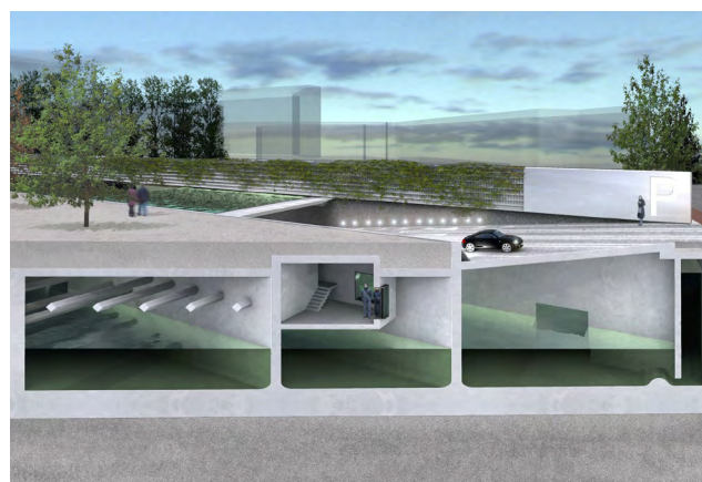
Fig. 69: Sezione schematica del parcheggio sotterraneo con volume di ritenzione
