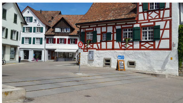
Fig. 33: Dosso artificiale all'ingresso del centro storico per deviare il ruscellamento superficiale a Steckborn
