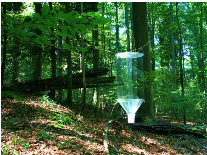
Abbildung A4.2: Kreuzfensterfallen des Typs Polytrap™ werden mit Schnüren in der Regel zwischen zwei Bäumen aufgehängt. Links: Beispiel einer im Wald hängenden Kreuzfensterfalle Foto: E. Haeler. Rechts: Schematischer Aufbau der Kreuzfensterfalle abgewandelt nach Brustel (2010), Zeichnung: N. Roth.
