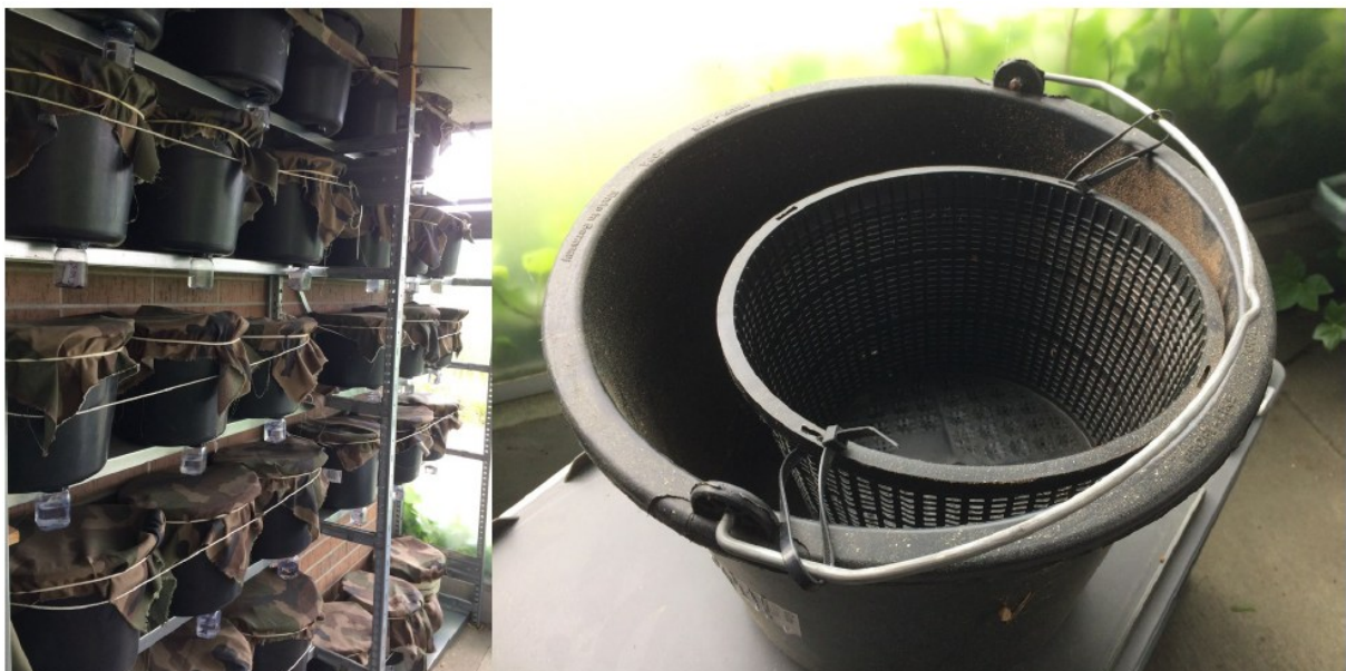
Abbildung A4.3: Anordnung (links) und Aufbau (rechts) der Schlupffallen für das Austreiben des Gesiebematerials. Fotos: N. Roth.
