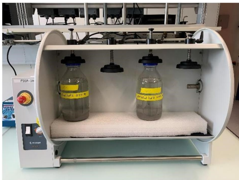
Abbildung 1: Herstellung der Eluate auf dem Überkopfschüttler bei 1 U/min.
