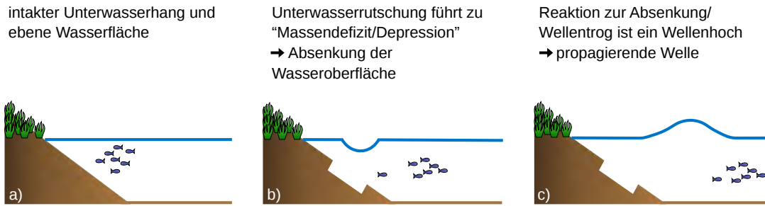
Abbildung 2.3: Die Abbildung zeigt das Konzept für die Tsunamigenerierung aufgrund von SAQM. a) zeigt den Zustand vor der subaquatischen Massenbewegung. b) verdeutlicht wie das abgerutschte Sediment eine Veränderung der Wasseroberfläche nach sich zieht und einen Wellentrog induziert, und sich in c) folglich als Welle ausbreitet.
