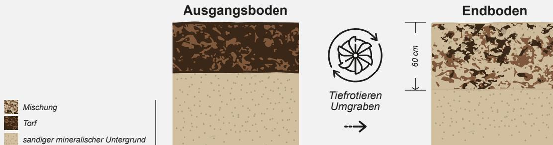
Abb. 24: Vereinfachte Darstellung vom Tiefrotieren des Bodens (angepasst nach [39]).
