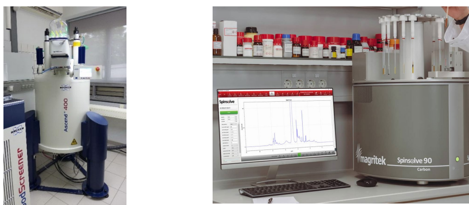
Abbildung 24: Links: Standard NMR Gerät (Quelle: bruker.com); Rechts: Benchtop-NMR Gerät (Quelle: magritek.com). Der geringe Platzbedarf und vergleichsweise niedrige Preis von Benchtop-NMR Geräten ermöglichen eine verbreitete Anwendung entsprechender Analysemethoden.
