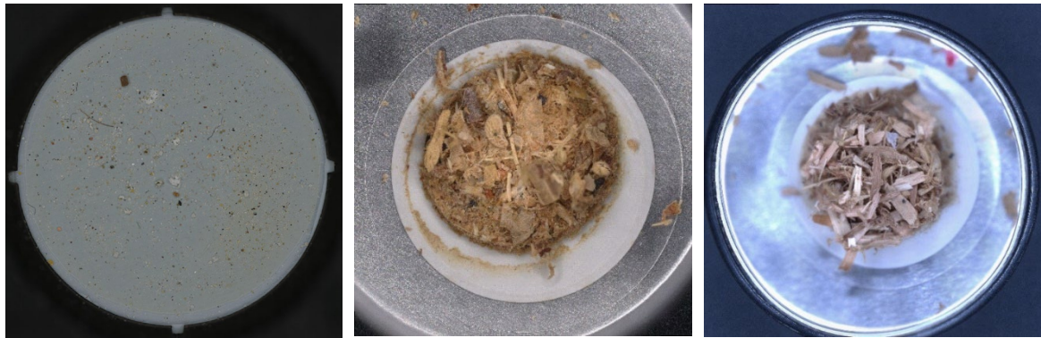
Abbildung 34: FT-IR-Filter mit den Filtrerrückständen aus den Matrizen Boden (links), Kompost (Mitte) und Gärgut (rechts).
