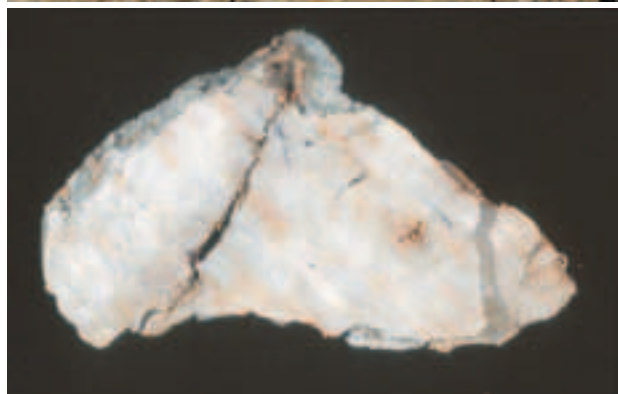
Fig. 58: Macchie di ruggine
